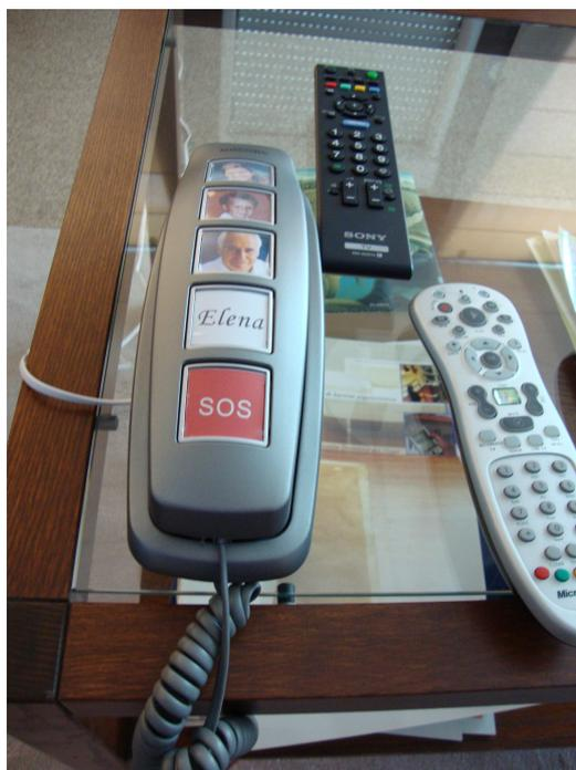
FIGURA 5.6. Teléfono góndola con sistema de marcación automática a los números pregrabados de los principales contactos en botones grandes con sus fotos. Foto tomada con permiso en julio de 2009 en el Hogar Digital Accesible de la EUIT de Telecomunicación de la Universidad Politécnica de Madrid<sup>58</sup>, tras asistir a una prueba de uso de un nuevo servicio de teleasistencia.
