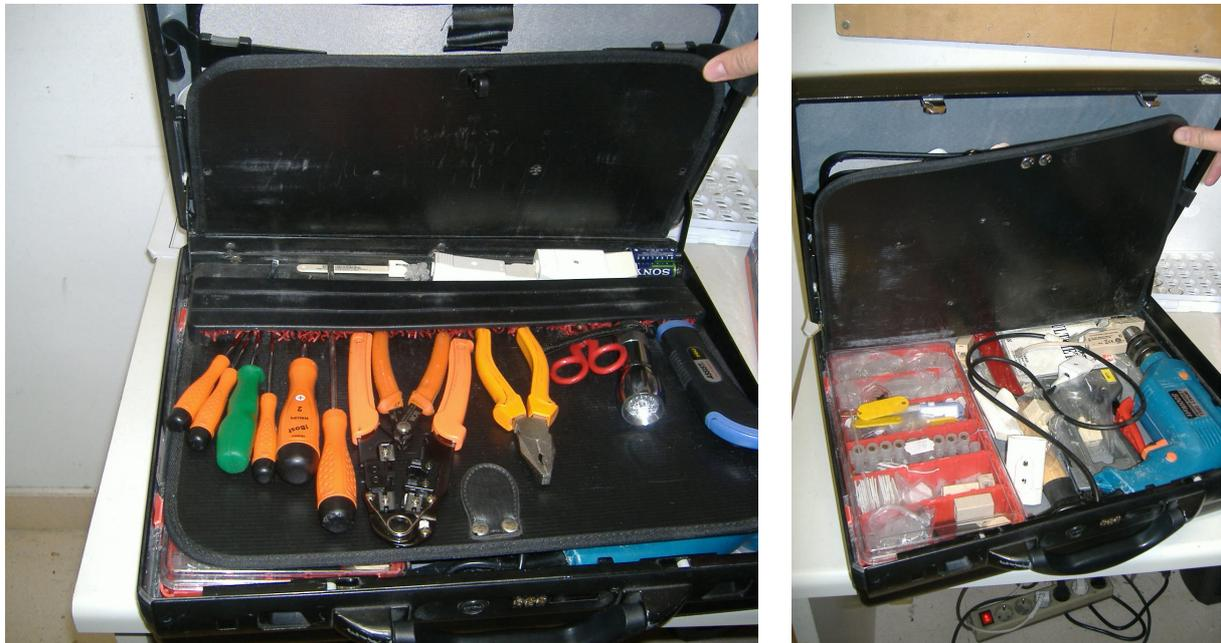
FIGURA 3.9. Maleta de técnicos instaladores, mostrada por L: Primer y segundo compartimento. Fotos tomadas en otoño de 2008 por el autor.
